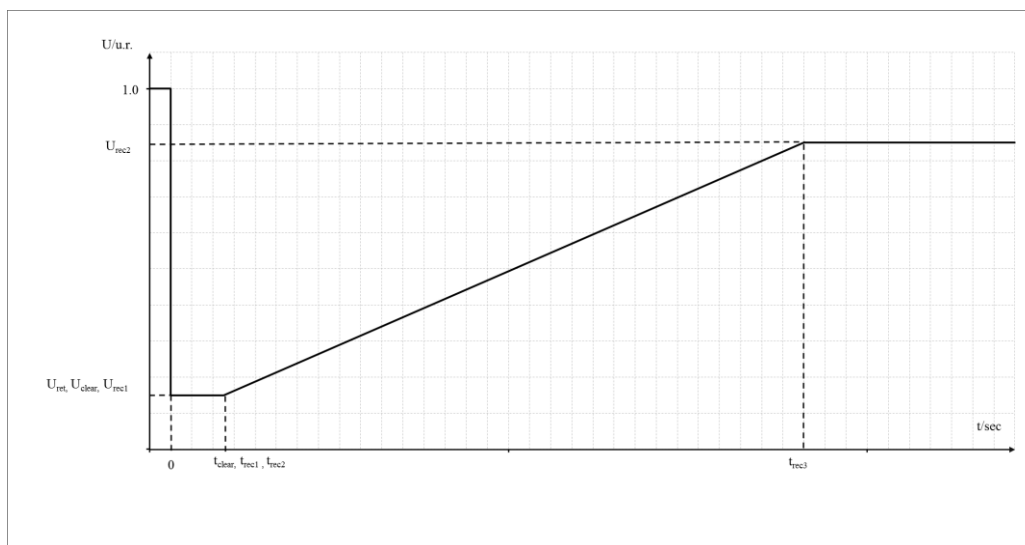
Fig. 3B. Diagrama de capabilitate privind trecerea peste defect a unei centrale formate din module generatoare, de categorie B
